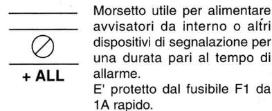
Fig. 4. Uscita con tensione di "riferimento" (13 V); è adatta per il comando di sirene autoalimentate
