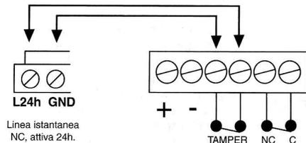
Fig. 9. Ingressi NC delle linee L1 L2 L3 L4 (dal morsetto 14 al 19).
