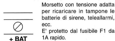
Fig. 3. Uscita di allarme a tensione 13,8 V disponibile solo durante l' allarme generale.
